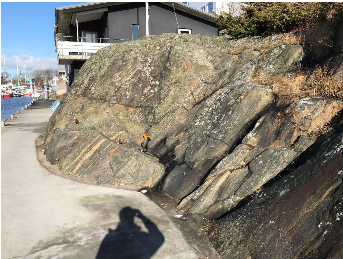
Figur 7. Mycket av bergmassan på tomten är storblockig (blockstorlek motsv. 0,6-2 m)
