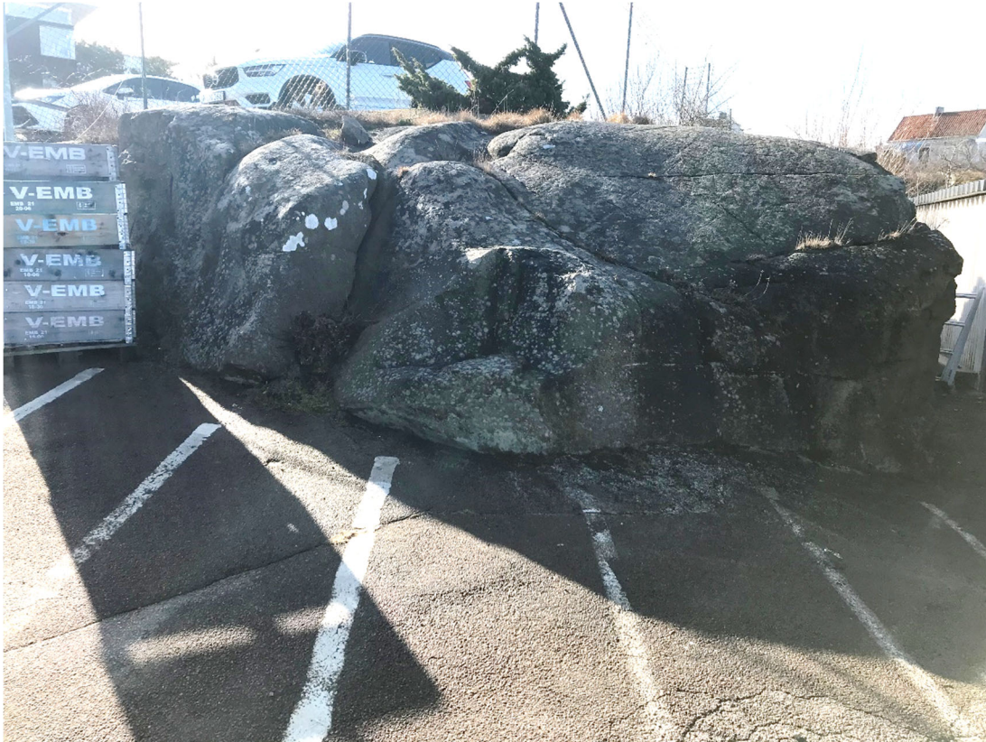
Figur 7. Mycket av bergmassan på tomten är storblockig (blockstorlek motsv. 0,6-2 m)
